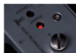
DC成分の検出回路で検知されたDC成分は、レベルに応じてDC Sensorのランプの明るさを変化させる仕組み
