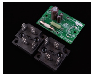
メインデバイスであるブリッジダイオードとDC検出基板
