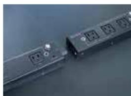
Force bar シリーズは、インレットが IEC60320 の C14 に統一されています。Force bar L1P には同インレットに対応する C13 (連結コンセント) を採用しており、他の Force bar との連結が可能です。Force bar L1P には出力コンセントが1口装備されていますが、Force bar 3.1 や Force bar 6.1 と連結することで、簡単に出力コンセント数を増やすことができます。これは、突入電流を抑制したいオーディオ機器が複数台になる場合、非常に有効です。
