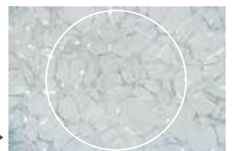
エッチング処理による導体表面の空洞化(イメージ)
