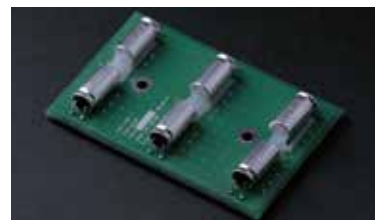
両面ベタ基板に実装された6機の特殊アルミ電解コンデンサ
